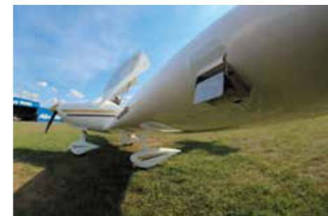
Roman Konecny, présente les deux systèmes d'alarme de décrochage désormais installés sur le WT-9 LSA.
